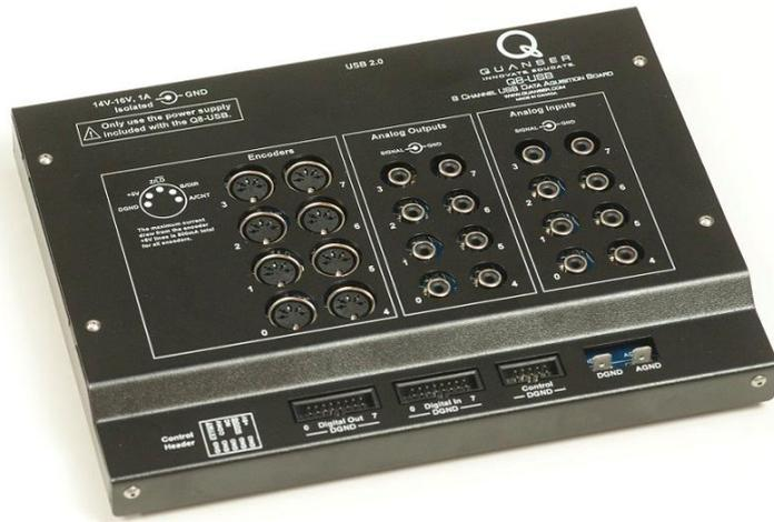
Figura B.5: Tarjeta de adquisición de datos Q8-USB
