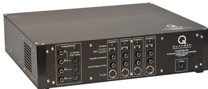
Figura B.6: Amplificador VoltPaQ-X4
