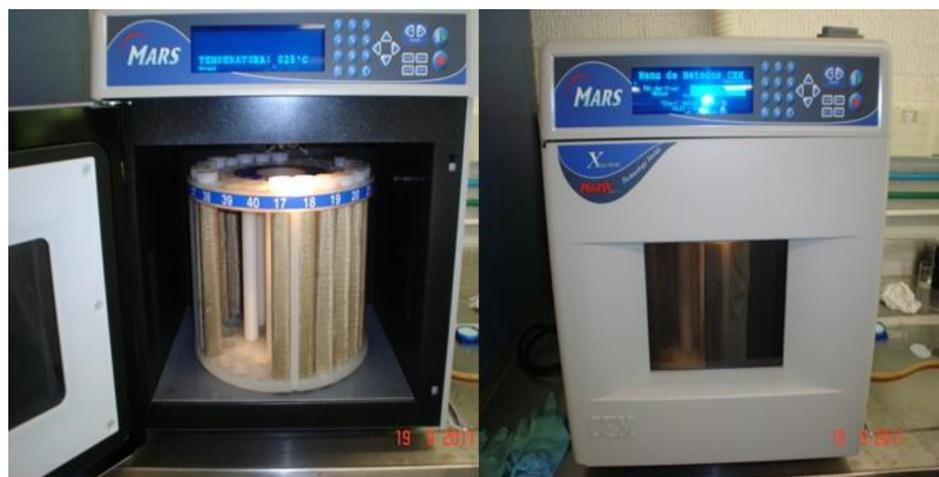
Figura 19. Digestor de Microondas MARS.
