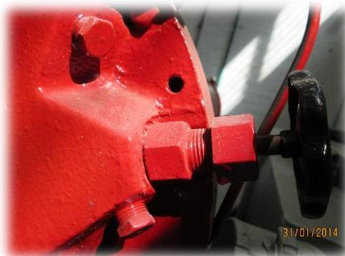
**Figura 2.2.** Válvula manual ensamblada en la turbina
