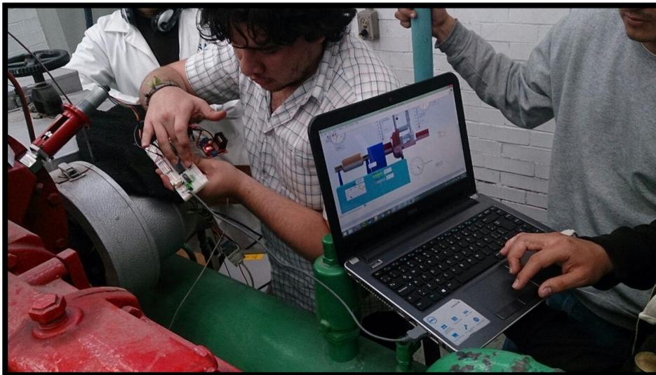
**Figura 4.4.** Montaje de la válvula sin carcasa en la turbina durante el primer ensayo en sitio.
