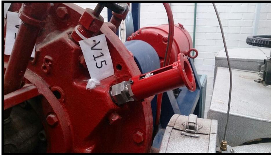
**Figura 4.3** Montaje de la válvula sin motor durante el primer ensayo en sitio.
