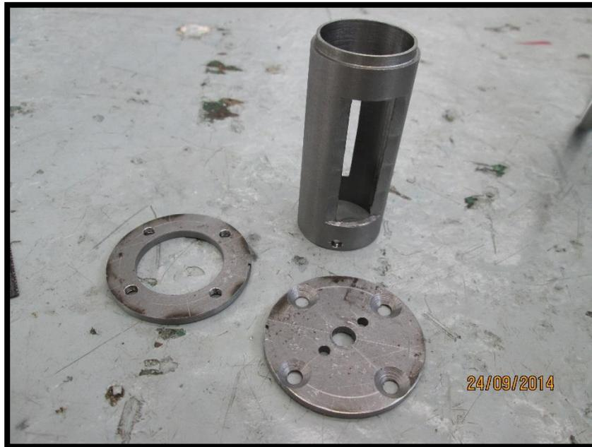
Figura 3.22 Soporte de motor sin terminar
