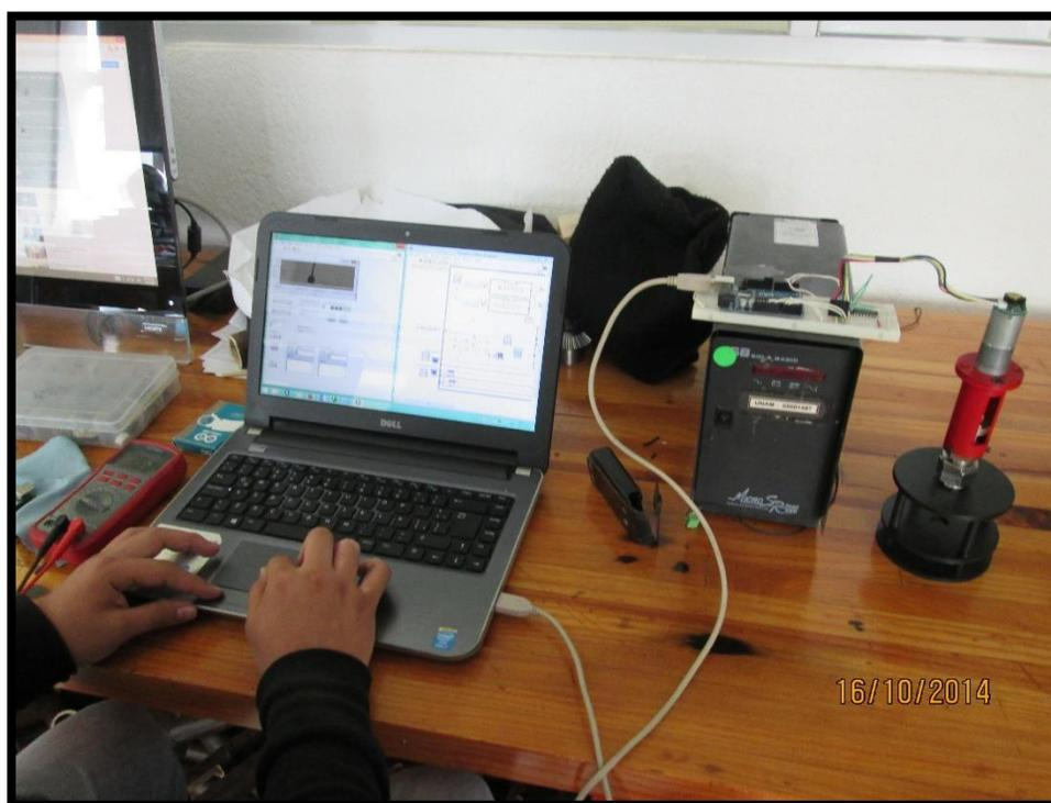
Figura 4.1 Primer experimento, válvula montada en su mesa de pruebas.
