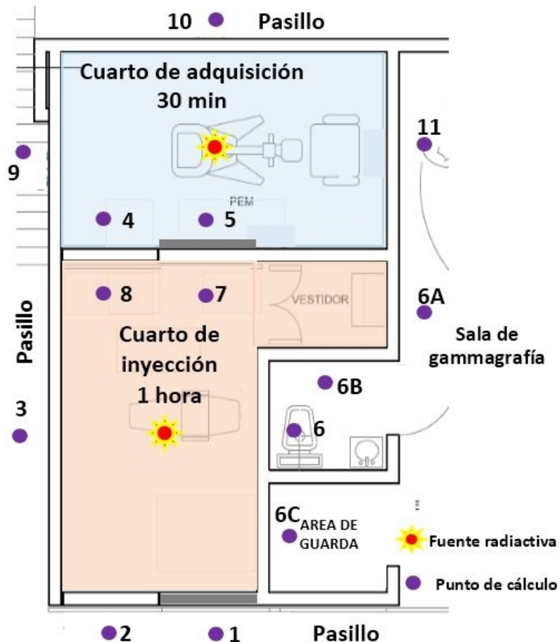
Fig. 4.1: Esquema del área que albergará el PEM y sus barreras.
