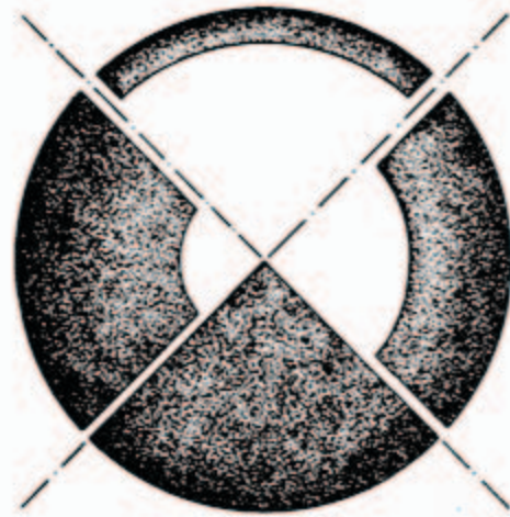
DIFERENTES SECCIONES SEGUN ESPECIES DE BAMBÚ SEGÚN LA ESPECIE EL ESPESOR VARIA O ES SÓLIDO
