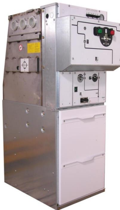
Figura 3. 7. Seccionador FBX , función CB , protección de alimentador con interruptor de operación en vacío y mecanismo de puesta a tierra.
