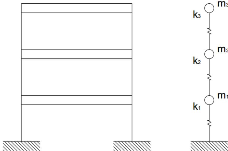
**Figura 2.2** Idealización de una estructura a base de masas (m) y resortes (k)
