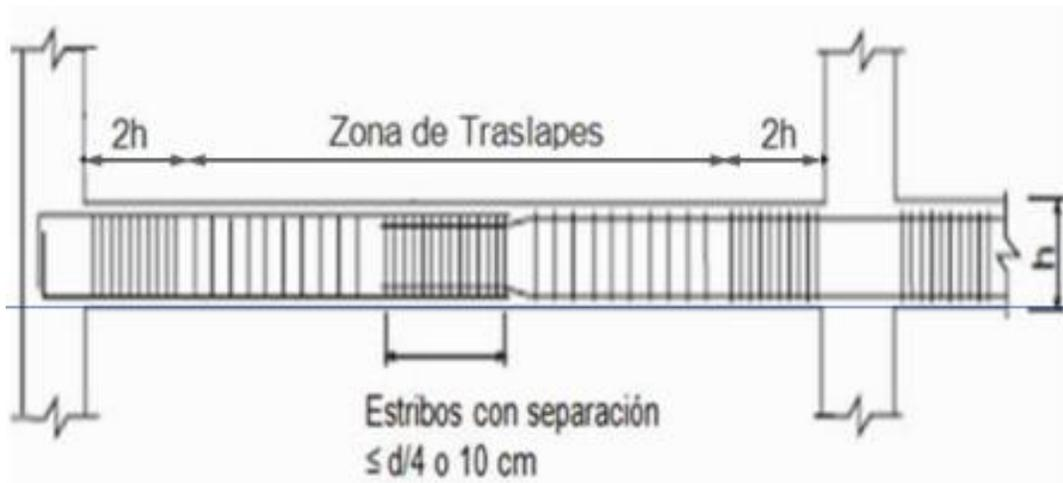
**Figura 2.7** Zonas de traslapes aceptadas y separación máxima de estribos en vigas de marcos dúctiles según el RCDF-2004
