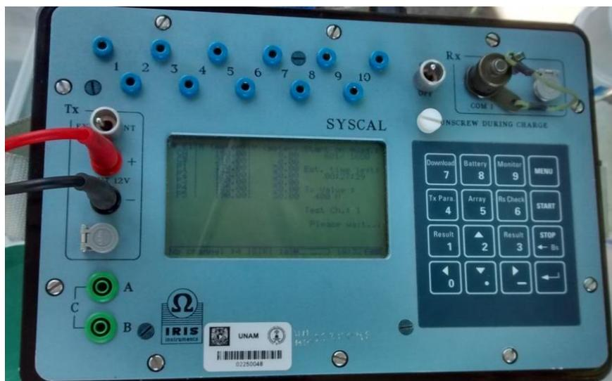
Figura 4.6 Consola Syscal Pro Switch realizando mediciones.
