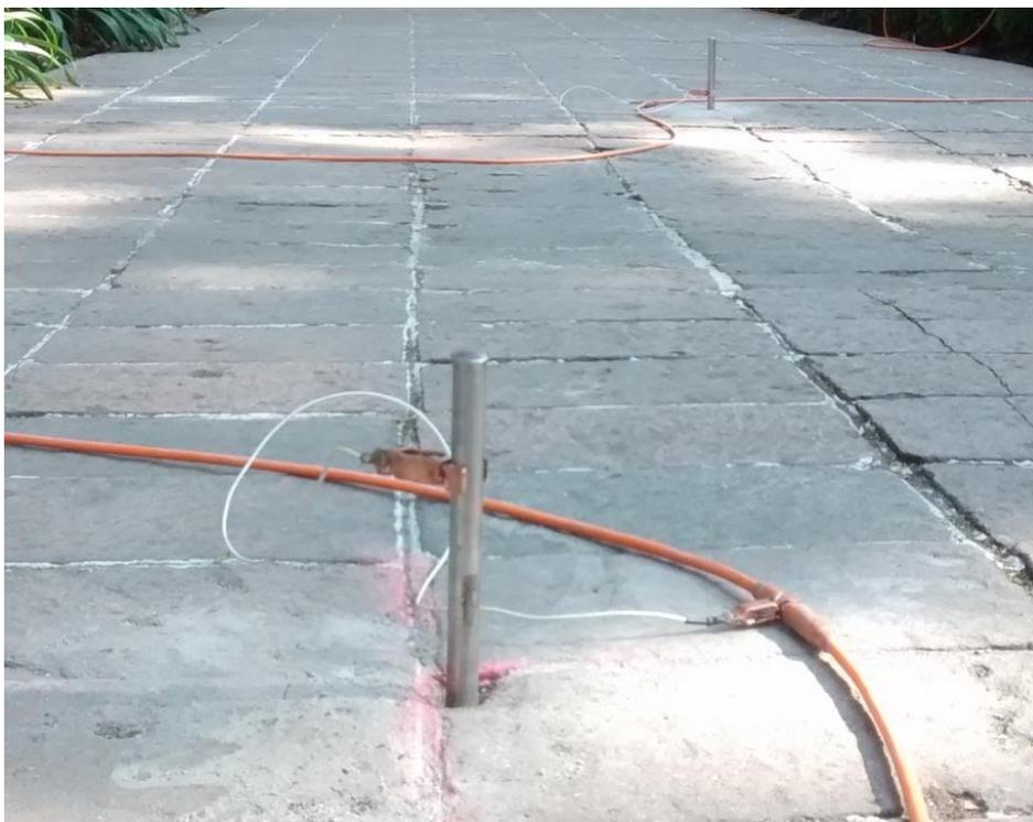
Figura 4.5 Electrodo enterrado y conectado a cable.
