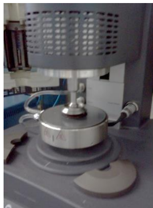
Figura 40.- Geometría de platos paralelos. Útil para medición de viscosidades bajas.
