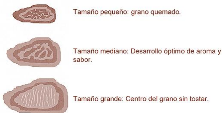
Figura 15.- Efecto del tamaño del grano en el grado de tostado.
