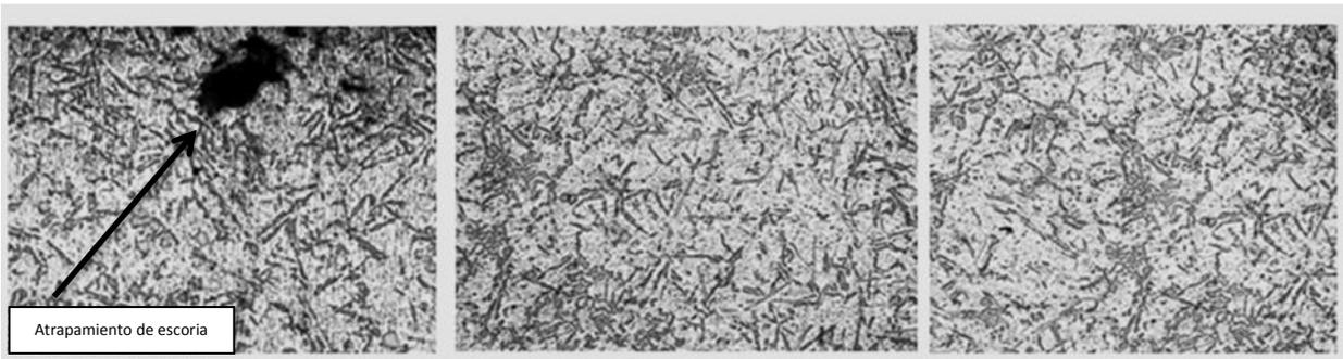
Figura 4.4a Metalografía usando 400g de fundente ataque HF a 100x
