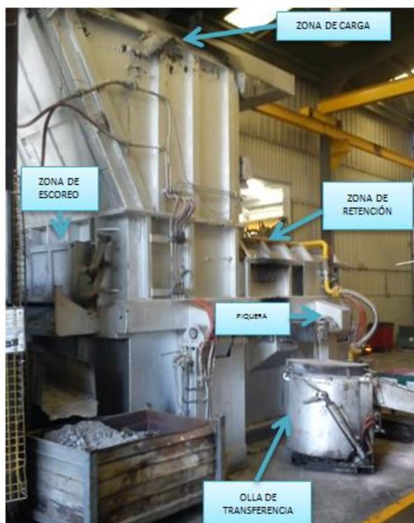
Figura 3.3 Detalle horno de reverbero de BSI.
