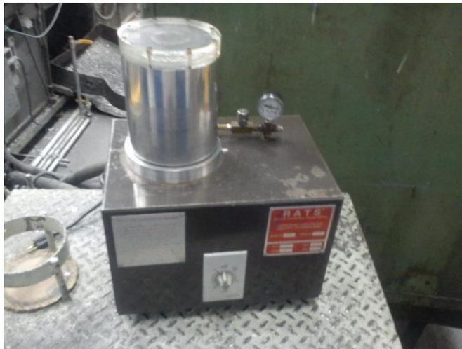
Figura 1.7 Equipo utilizado para realizar la prueba de presión reducida marca RATE®.
