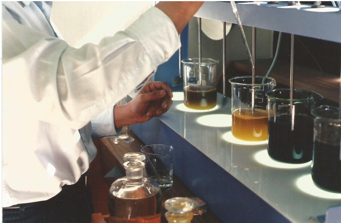
Figura. 2-6. Preparación de muestra de lixiviado para realizar pruebas de dosificación de reactivos en el tratamiento fisicoquímico “Prueba de jarras”.
