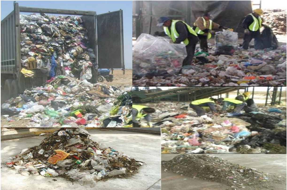
Figura 2-1. Preparación de residuos para realizar el cuarteo.
