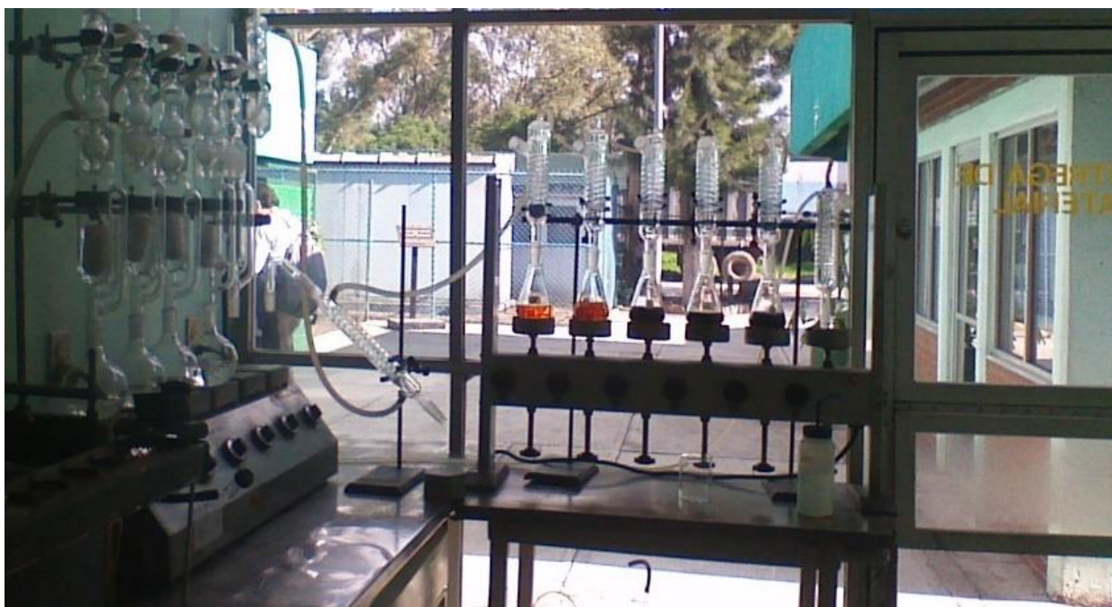
Figura 4-8. Determinación de DQO y grasas y aceites en el Laboratorio Central de Biología Ambiental de la DTDF.
