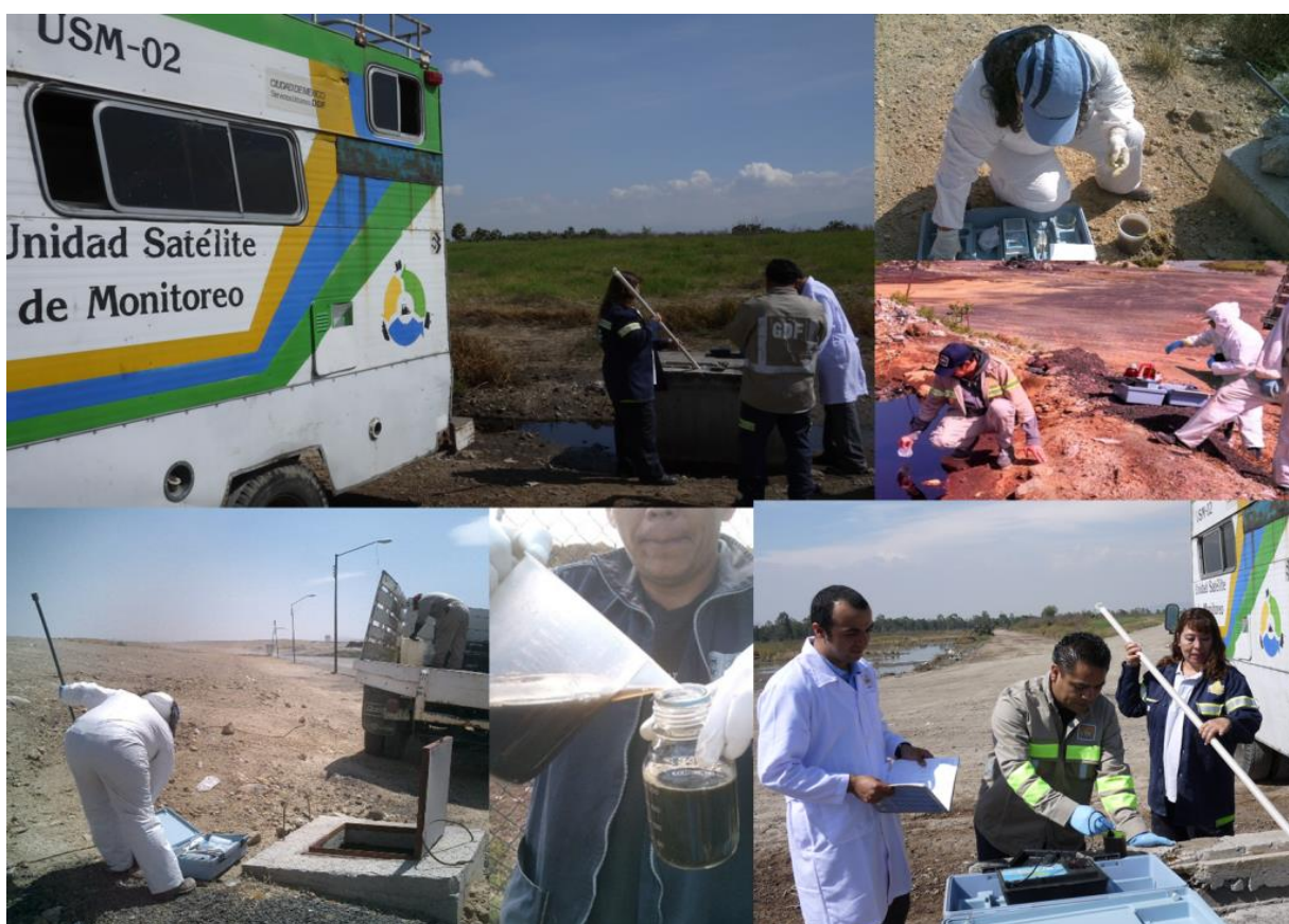
Figura 4-1. Muestreos de lixiviado y medición de parámetros en campo.
