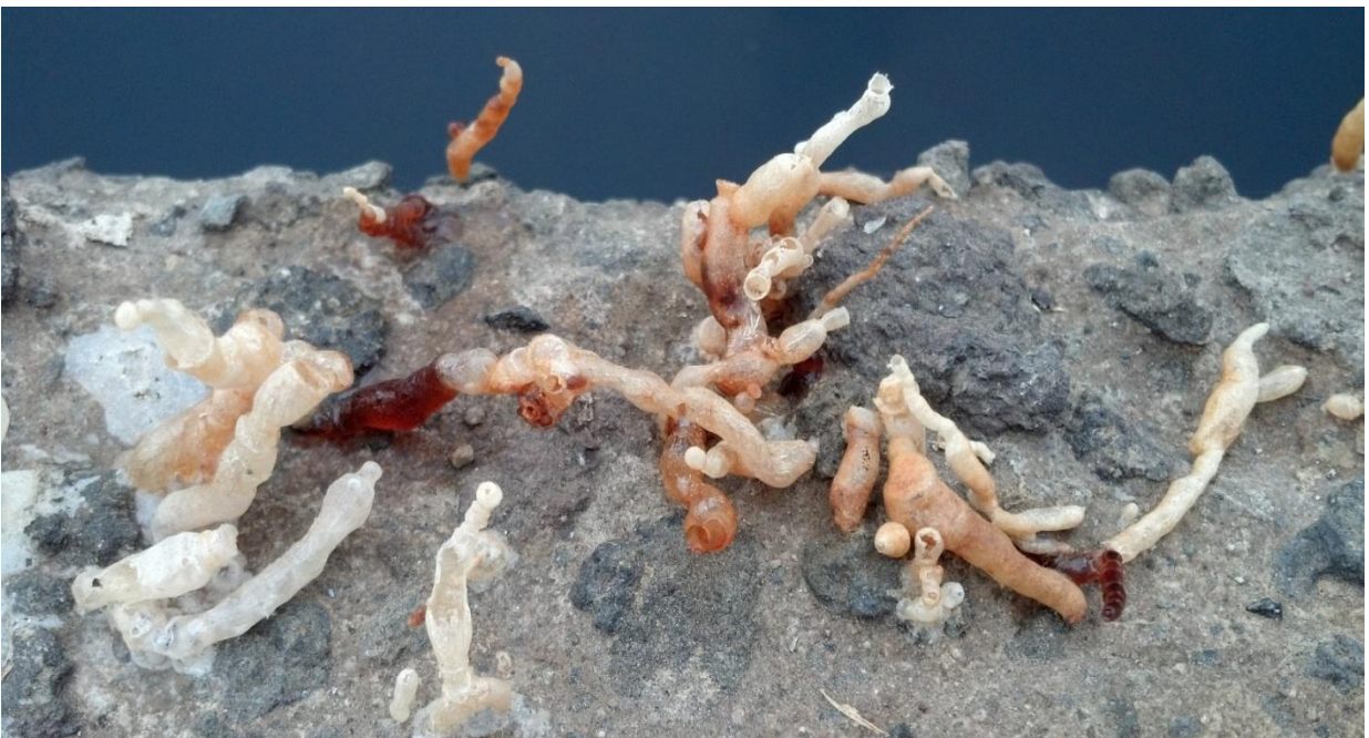
Figura 8-2. Lixiviado en el interior de un “tubo”.
