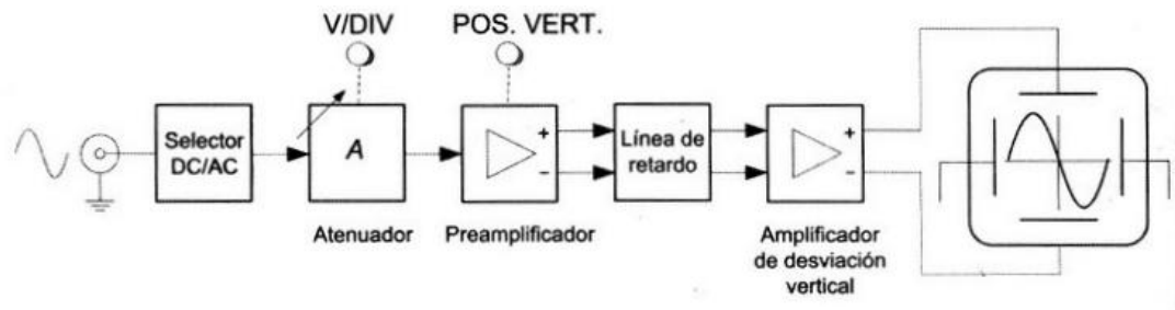
Fig.47.- Estructura del sistema de desviación vertical.
