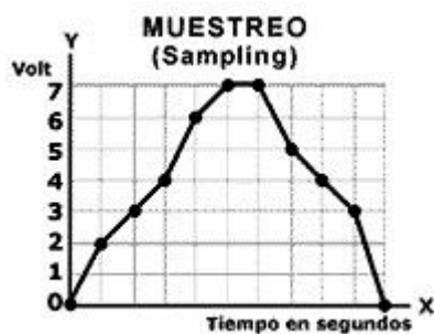
Fig.33.Muestreo de una señal analógica.
