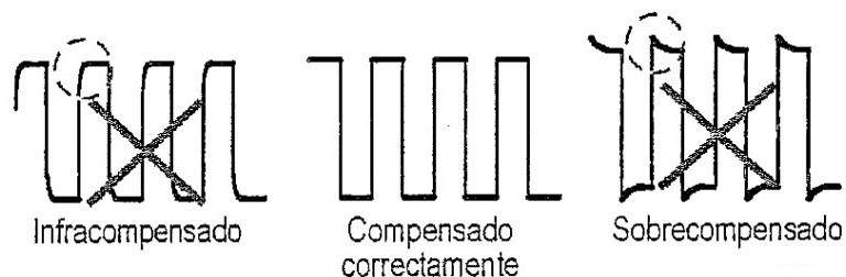
Fig.101.-compensacion correcta de la sonda.
