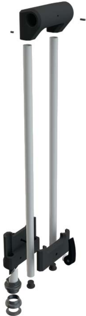
Figura 5.4.1 Despiece de dirección
