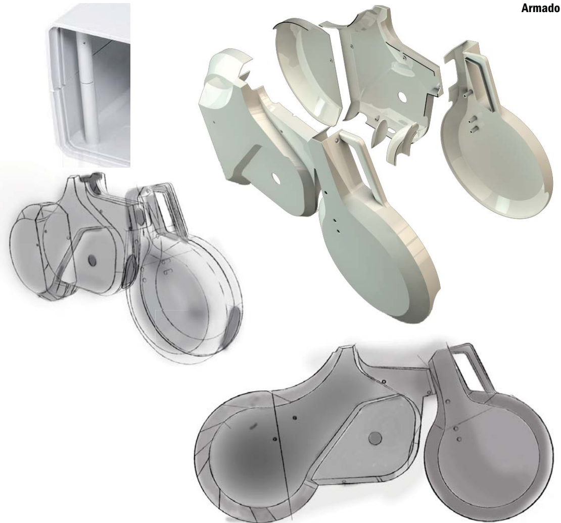
Figura 5.5.9 Armado de asiento
