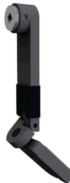
Figura 5.3.9 Vista posterior de biela
