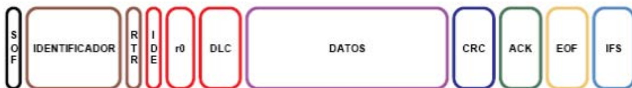
Figura 3.2.2.2 Trama de Datos de CAN
