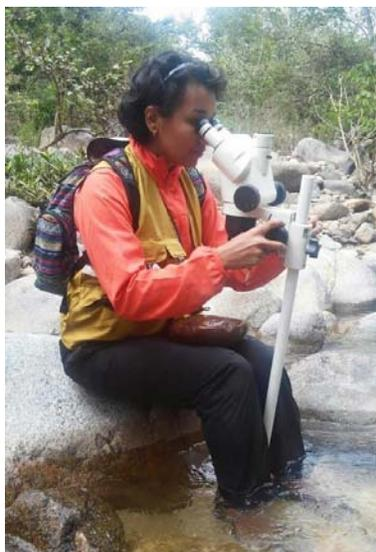
Figura 25. Adaptación de microscopio estereoscópico con un tubo de PVC para poder observar las rocas dentro del río. (Tomada por: Margarita Collazo)
