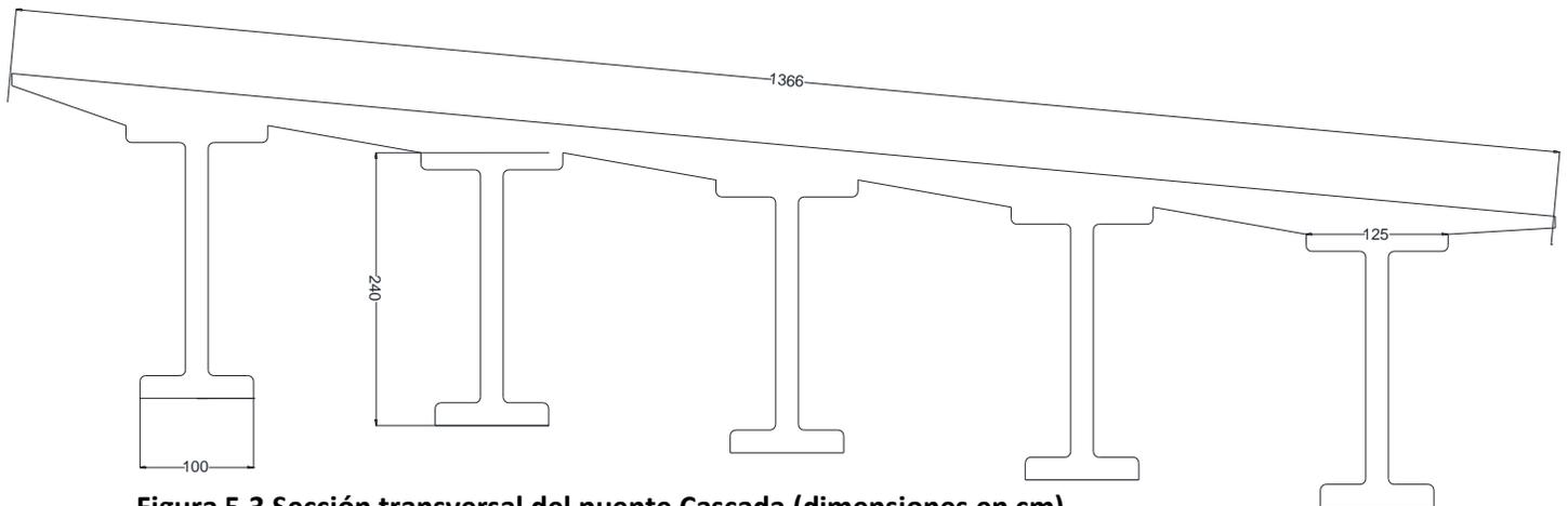
**Figura 5.3** Sección transversal del puente Cascada (dimensiones en cm)
