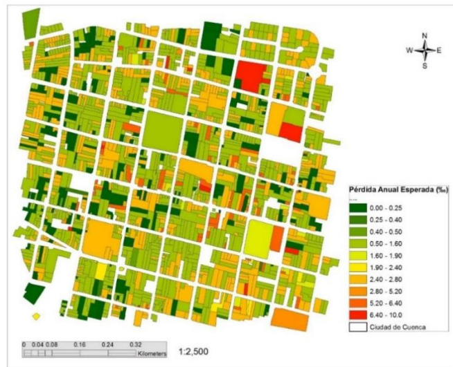
Figura 7-4 Pérdida Anual Esperada económica de las edificaciones de una de las zonas céntricas de Cuenca sin considerar efectos de sitio
