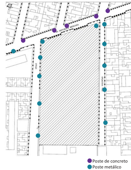
ILUSTRACIÓN 28. UBICACIÓN DE LUMINARIAS
