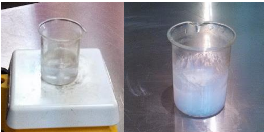
Figura 2.2 Solución homogénea (Izquierda). Precipitado de Y_2O_3:Eu^{3+} (Derecha)
