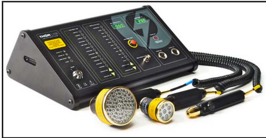
Figura 12: la figura ejemplifica la diferencia entre un cabezal sencillo y uno múltiple (también conocido como cluster en inglés). Esta es una máquina de láser de la marca THOR Photomedicine Ltd., la cual tiene productos específicamente para uso en caballos.
