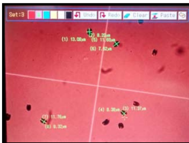
Figura 10: muestra la pantalla de la cámara del microscopio que permite realizar las mediciones de las microalgas.
