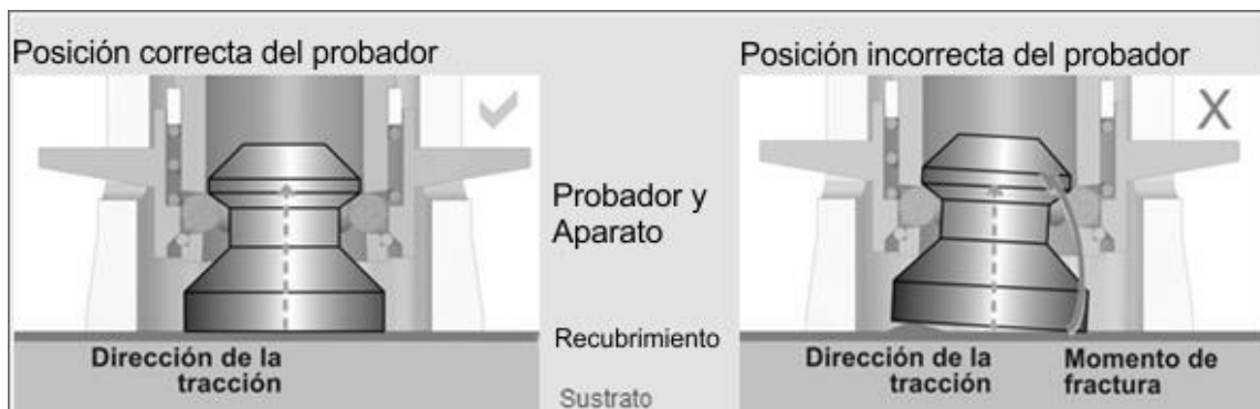
Figura 1.12 Colocación adecuada del pistón para las pruebas de Pull-off
