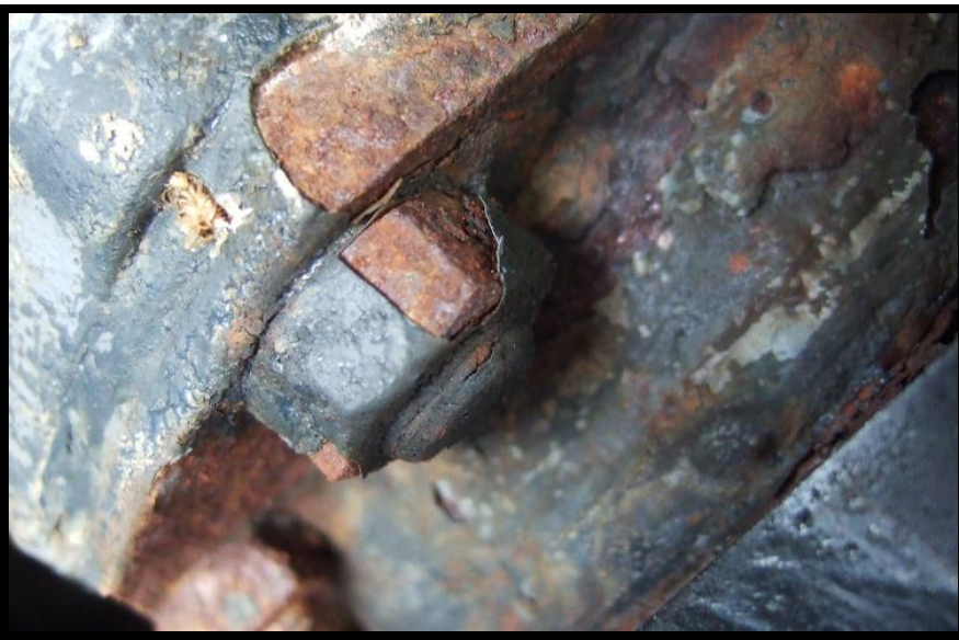
Fotografía 1.1 Ejemplo de efecto de corrosión, encontrada en el motor Lycoming IO-540 [29]
