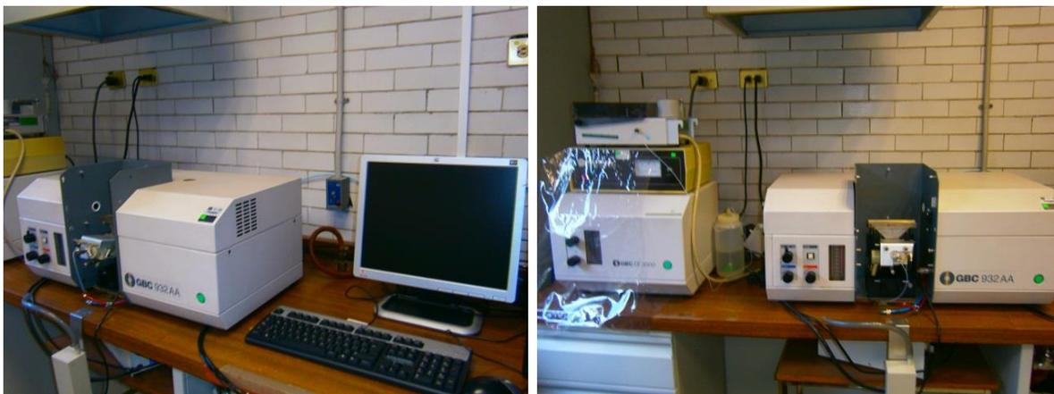
Para la determinación de Ca, K, Mg y Na, se tomaron 10 mL de muestra por duplicado, se adicionó 1 mL de cloruro de cesio (para evitar interferencias de ionización) a las muestras en las que se analizaron Na y K y un 1 mL de óxido de lantano (para evitar interferencias de ionización) para las muestras en las que se analizó Ca y Mg.
