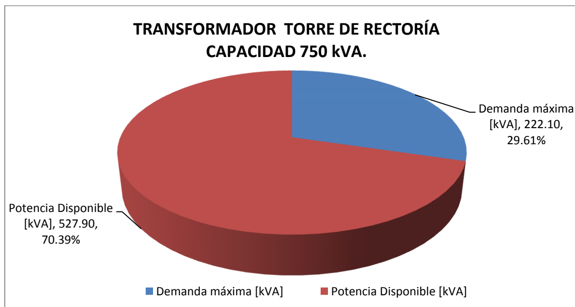
Grafica 2.22 Potencia disponible en el transformador
