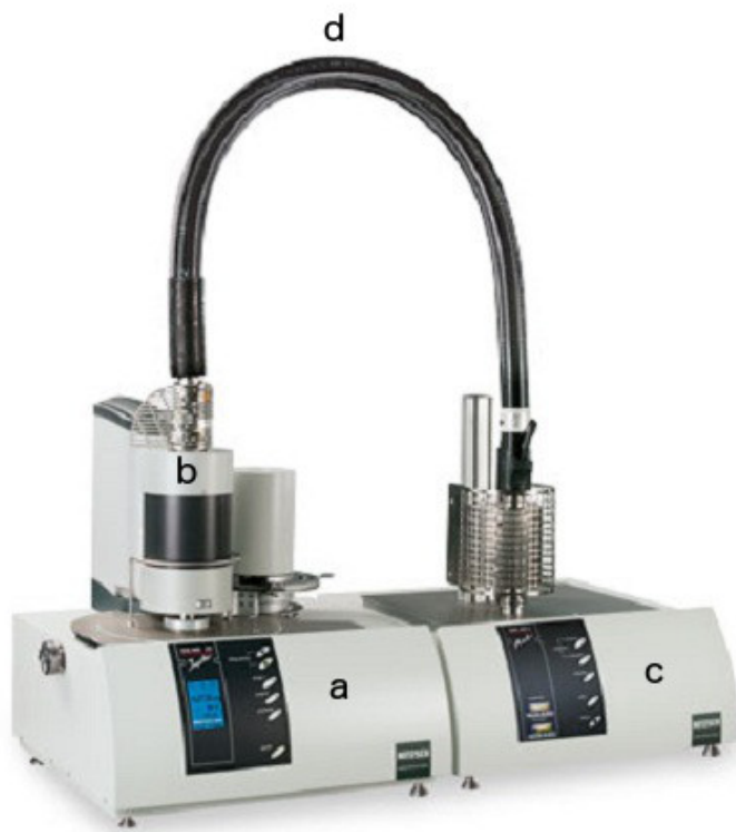
Figura 5.4 Configuración del equipo acoplado TGA-DSC-MS. Esquema en el que se muestran los instrumentos del equipo. a. Balanza para el análisis termogravimétrico. b. Horno para los análisis de TGA y DSC. c. Espectrómetro de masas. d. Interfase. Obtenida de Netzsch.
