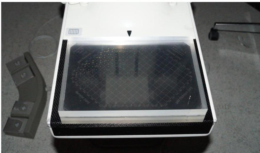
Figura 4.1: Configuración de referencia del maniquí CDMAM con las marcas de las placas de PMMA colocadas del lado derecho más cercano a la pared del tórax del bucky de la unidad de mamografía.
