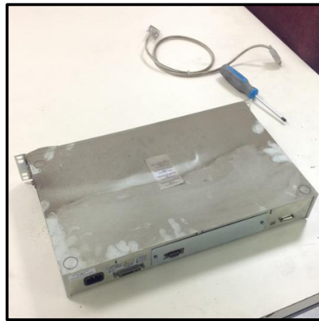
Figura 4. 2 Switch desmontado, vista trasera
