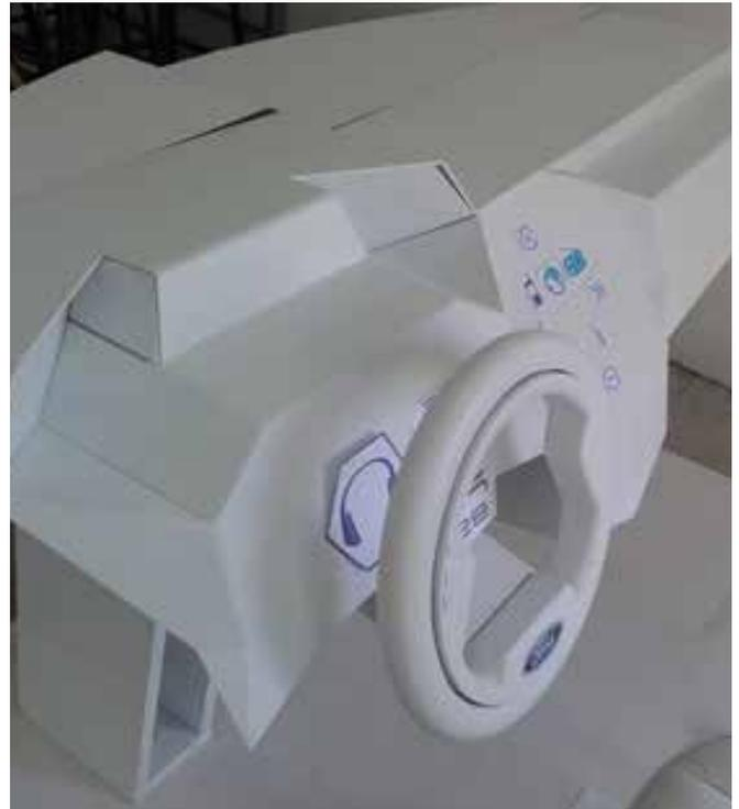
Al terminar la etapa de experimentación y pruebas ergonómicas con el simulador 1:1, se logró tener el acomodo óptimo de los elementos de la interfaz dentro del tablero, lo cual nos permitió seguir con la etapa de diseño de interfaz, de una manera más clara concisa y precisa, tomando en cuenta los resultados obtenidos de la experimentación con el mock up.
