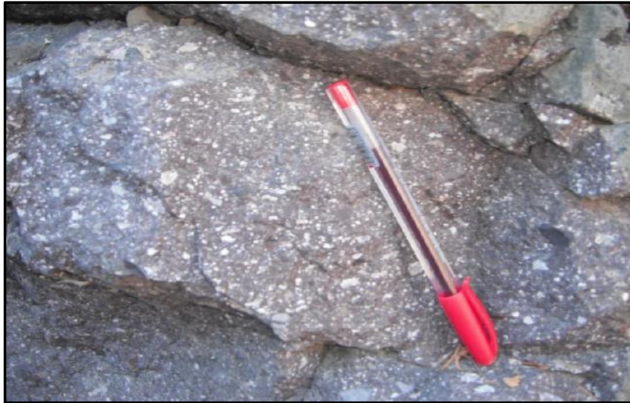
Figura 2.4 Textura fanerítica de la Formación Alisitos.
