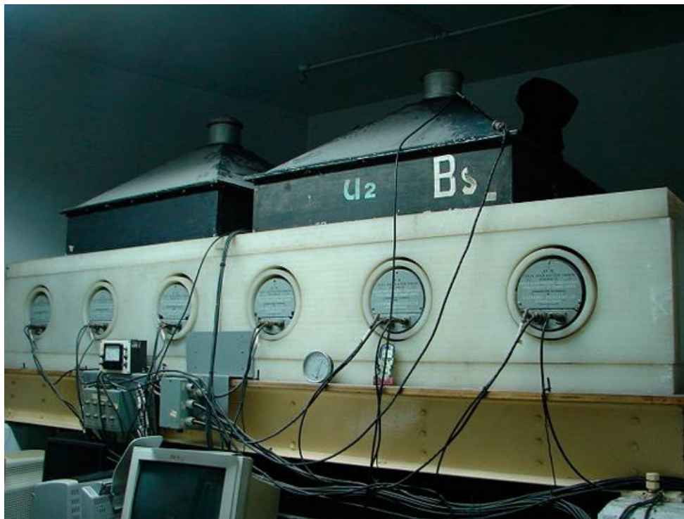
Figura 2.1. Monitor de Neutrones 6-NM64 instalado en el Observatorio de Rayos Cósmicos en Ciudad Universitaria.
