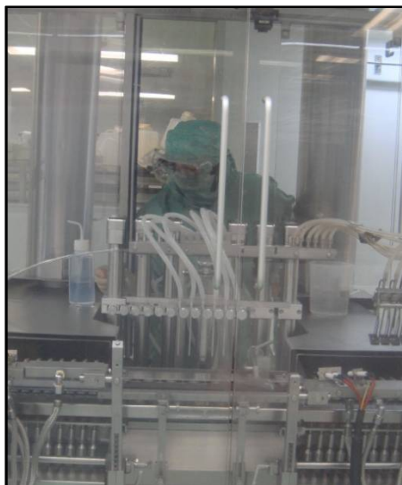
Armar las bombas de dosificado
