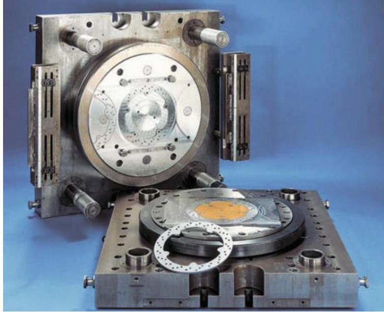
Figura 1.17 Matriz y punzón de un troquel (Klocke, 2013)
