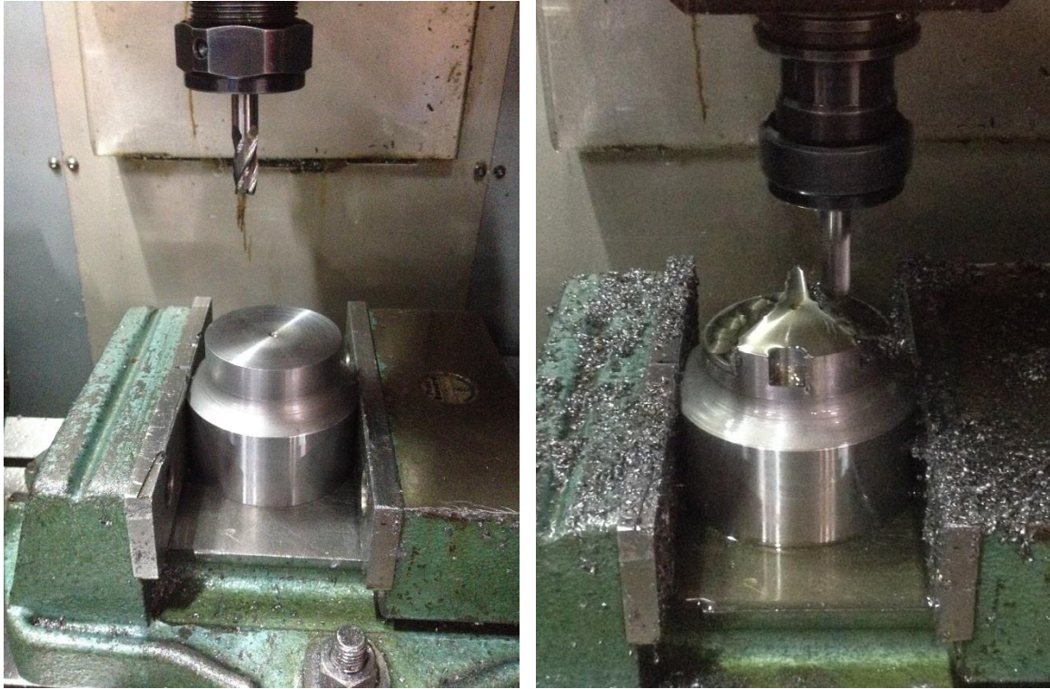
Figura 4.4 Maquinado del punzón en la máquina CNC
