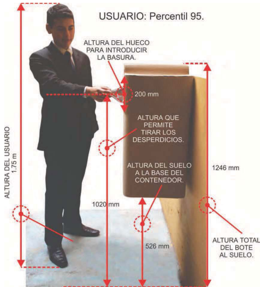
ESQUEMA 29/Descripción de alturas establecidas en el bote de basura aplicadas en el simulador y como funcionan en un usuario de percentil 95.
