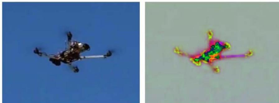
Figura 2.14: Comparativa de una Imagen en RGB contra una en HSV.
