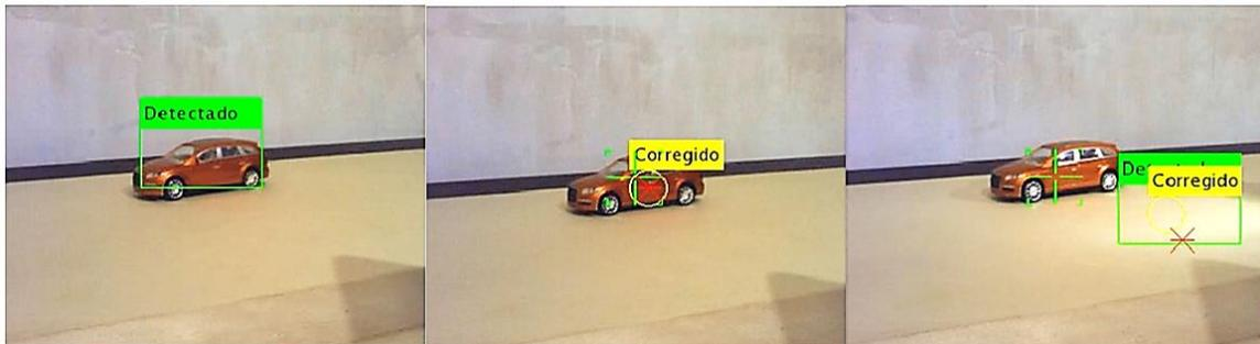
Figura 5.53: Efecto del seguimiento de color a diferente cambio de exposición.
