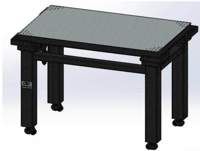
Figura 3.7 Modelo CAD de la mesa Newport con sistema neumático de elevación.
