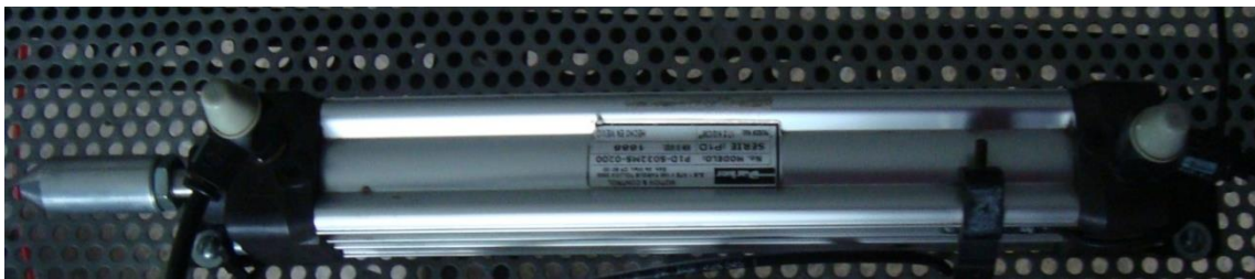
Figura 3.9 Pistón de doble efecto.
