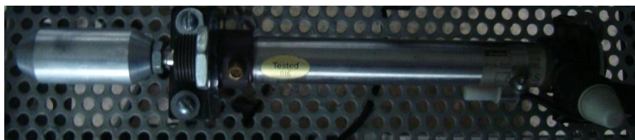
Figura 3.10 Pistón de simple efecto con regreso de resorte.
