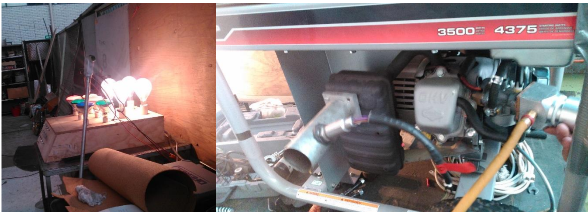
Figura 3.28. Prueba del mezclador de gases del motogenerador.
