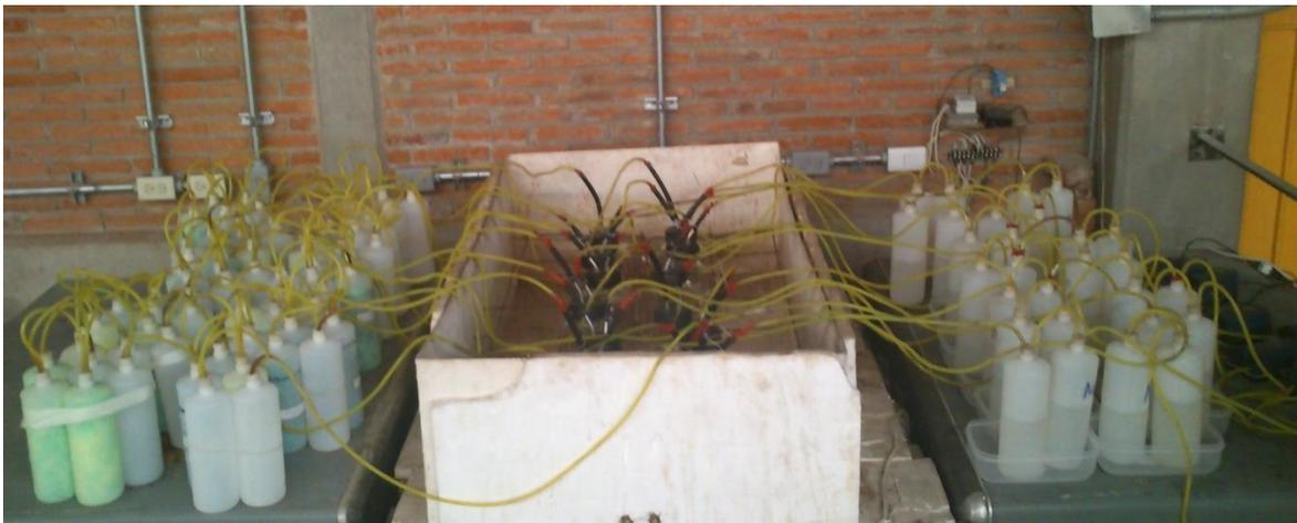
*Figura 12: Arreglo de reactores utilizados para la biodegradación de películas de LDPE (pLDPE) elaboradas con dos diferentes aditivos pro-oxidantes.*
