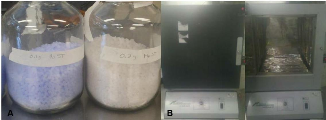
Figura 13: A) Perlas de polietileno mezcladas con aditivos pro-oxidantes. B) Horno marca Felisa en el cual se sometieron a termo-oxidación las películas elaboradas con aditivos pro-oxidantes.
