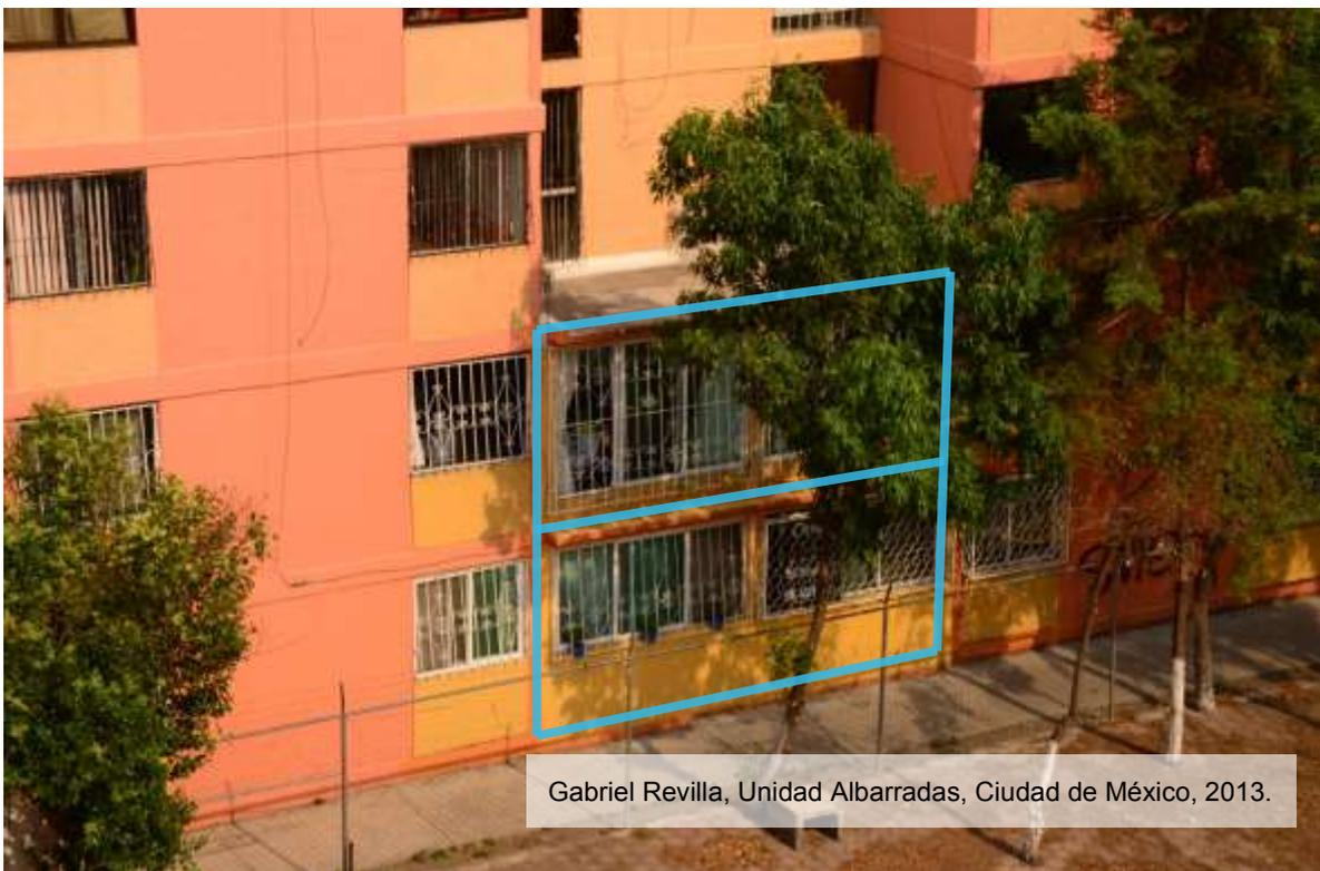
Fig. 4.22. Una vez que el vecino de planta baja ha alargado su sala-comedor no parece haber ningún impedimento para que el habitador del departamento superior haga lo propio; de esta manera el edificio completo empieza a ganar espacio. Encerrados en azul se observan dos departamentos en planta baja y dos en primer nivel que han invadido ese espacio vacío.
