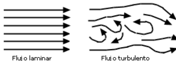
Figura 2. Diferencia de orden entre el flujo laminar y el flujo turbulento. Tomado de [8]
