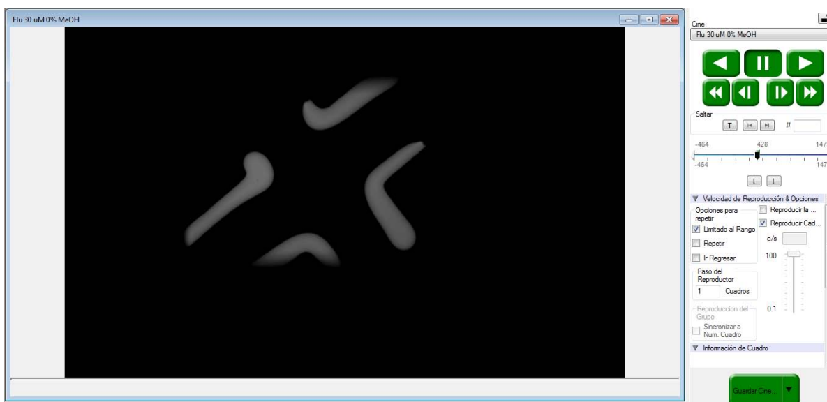
Figura 20. Pantalla del software PCC versión 2.2 con el que se toman las fotografías de las microgotas. La configuración de la cámara Phantom son: : Intervalo de apertura 10000 \mu s, Tiempo de exposición 3000.04 \mu s y Disparador a 660 722. 79 \mu s.
