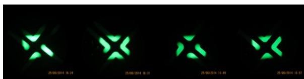
Figura 53. Secuencia de imágenes que muestra cómo va disminuyendo la intensidad de fluorescencia a medidas que disminuye la concentración de fluoresceína. Disminución de izquierda a derecha 30, 25, 15 y 5 \mu\text{M} . Configuración de la cámara: ISO 100, S =1/20 s, f= 3.5, sin Zoom, medidor de luz: Ponderado central, balance de blancos: Tungsteno. Microscopio: Objetivo 10x, 100% intensidad, 4to. cuadro de enfoque. Lámpara UV: 100% transmitancia.
