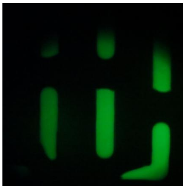
Figura 77. Span 80 al 0.1% m/m. Se presenta estabilización de las microgotas a través de los microcanales. [Fluoresceína] = 30 \mu M, flujo total= 100 \mu L/hr (Fase orgánica + fase acuosa). Configuración de la cámara digital: ISO 100, S =1/20 s, f=3.5.
