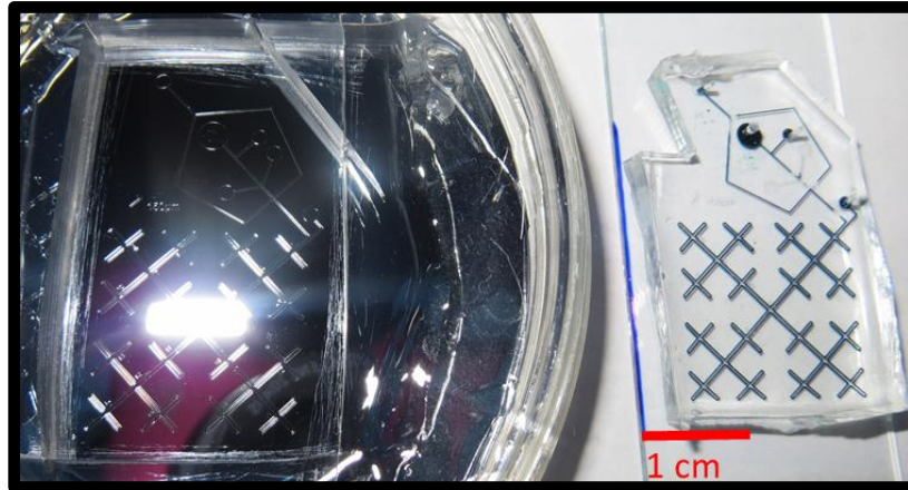
Figura 7. A la izquierda de la imagen está el micromolde con los relieves que se vuelven los microcanales en el microchip de PDMS a la derecha.
