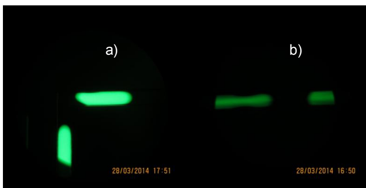
Figura 88. a) Fluorescencia al inicio del microcanal un flujo de 80 uL/h. [Fluoresceína] = 30 µM, flujo total= 80 µL/hr b) Fluorescencia al final de microcanal a un flujo de 80 µL/h. [Fluoresceína] = 30 µM, flujo total= 80 µL/hr. Configuración de la cámara digital: ISO 100, S =1/20 s, f=3.5.
