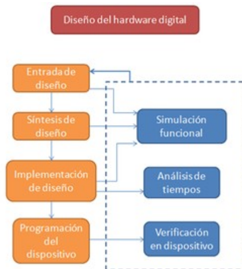
Figura 2.9: Diagrama del flujo de diseño de un FPGA. Recurso obtenido de [GENERA15].
