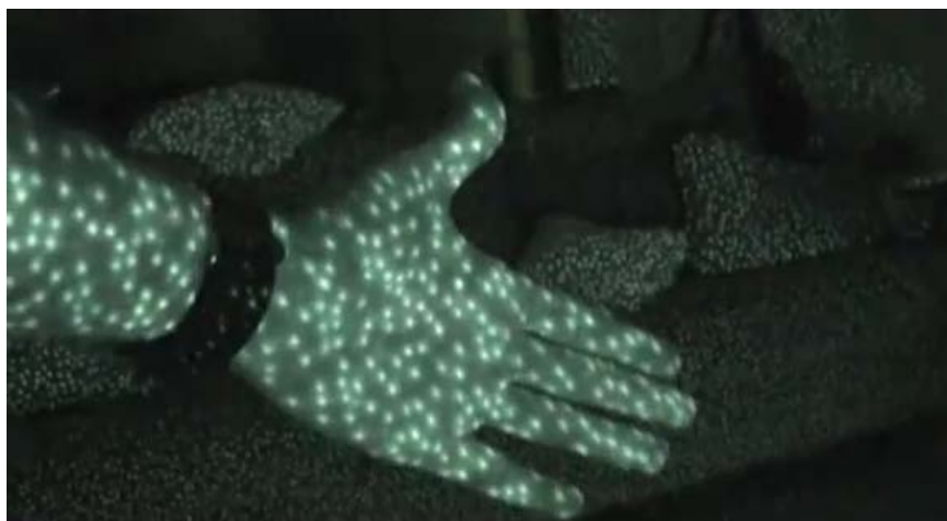
Figura 2.14: Patrón infrarrojo proyectado por una cámara RGB-D. Se proyecta el patrón en forma de puntos y la cámara observa la deformación de los puntos en la escena para generar información 3D.
