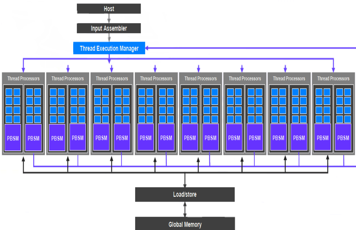
Figura 2.12: Diagrama de alto nivel de una GPU. (Recurso obtenido de [NVIDIA15])
