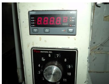
Figura 13. Selector de termopares manual y lector de temperaturas.
