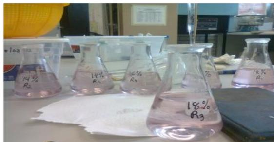
**Figura 29. Prueba de proteína por Micro Kjeldahl**
