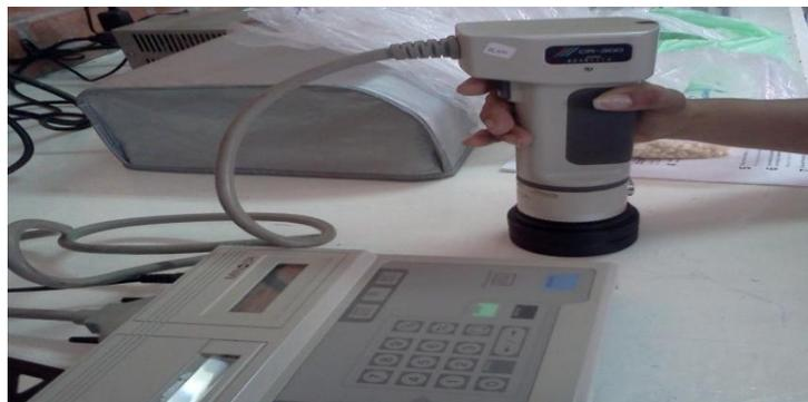
**Figura 28. Muestra del colorímetro del grano de maíz almacenado herméticamente.**
