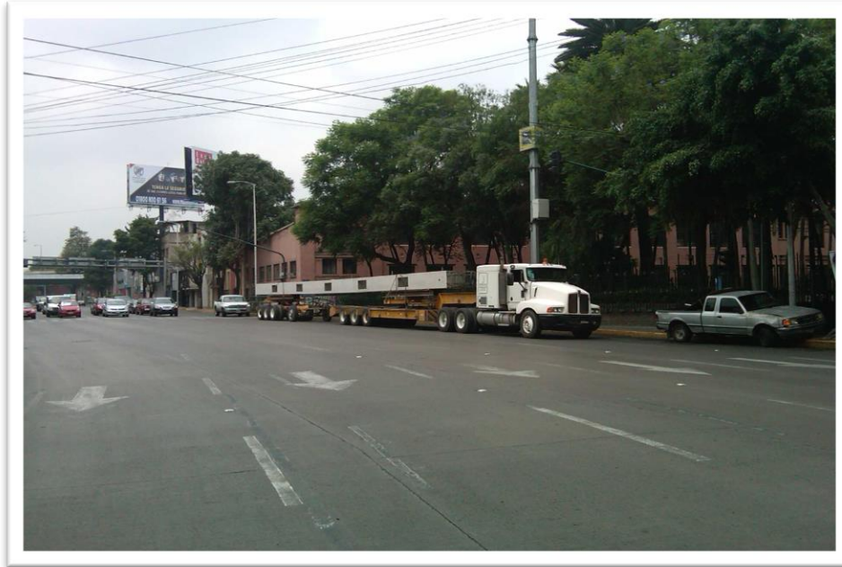
Figura 4.24. Transporte de columna sección 80 x 80 x 28.00 m de longitud en carga especializada (en este caso combinación low_boy-dolly con capacidad de transportar hasta 100 toneladas. Proyect: Taller Soni Revolución.
