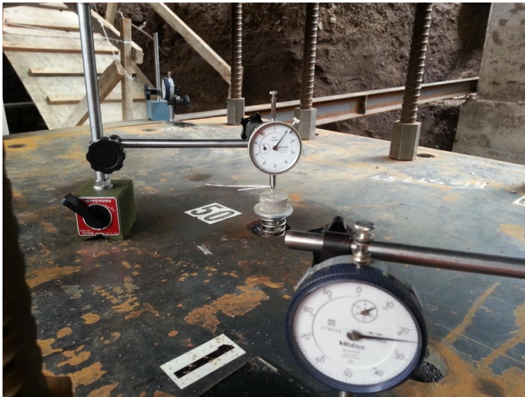
Figura 5.13 Parte exterior de Telltale y micrómetro para medición de deformación.
