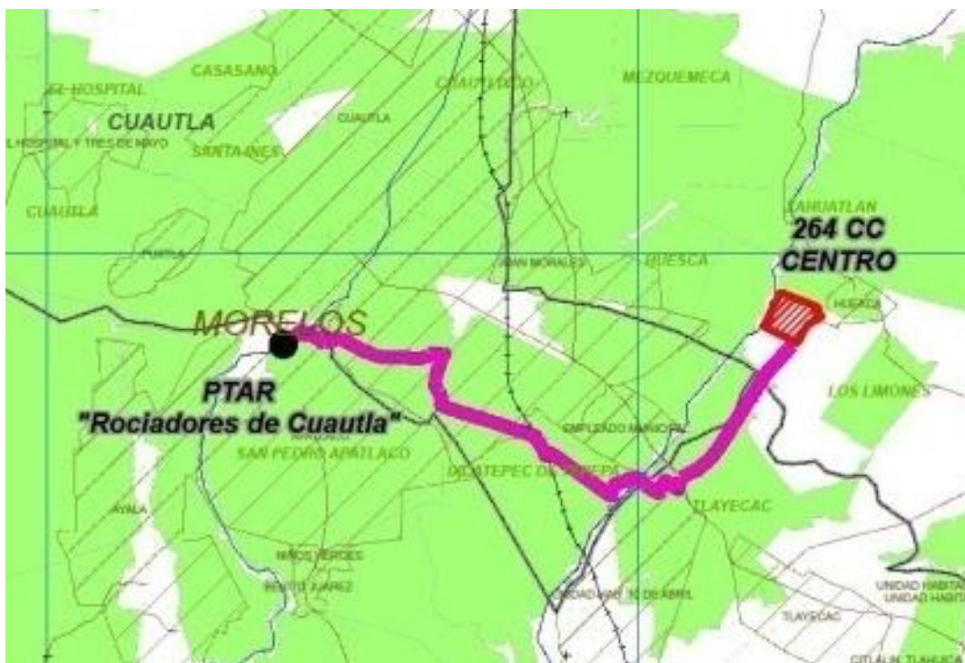
Figura 2.2 Trayectoria del acueducto a la 264 CC Centro a través de zonas ejidales.
