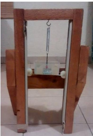
Figura 4. 8 Prototipo funcional del Sistema Masa-Resorte
