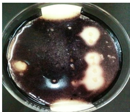
Figura 32. Imagen de una caja después de procesarse bajo la condición 3. El color violeta indica la presencia de almidón, ésta sólo desaparece cuando la \alpha -amilasa lo hidroliza (zonas amarillas claras).
