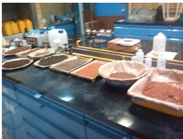
Figuras 13 y 14. Secado de muestras de suelo y jales a temperatura ambiente.
