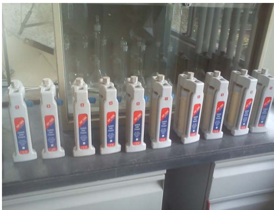
Figuras 15 y 16. Tubos de flurocarbón (liners) en los contenedores para la digestión ácida en el horno de microondas.
