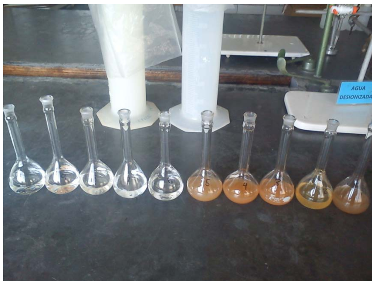
Figura 17. Extracción de especies solubles en las muestras de suelo.
