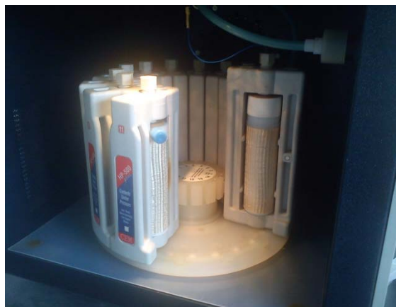
Figuras 15 y 16. Tubos de flurocarbón (liners) en los contenedores para la digestión ácida en el horno de microondas.
