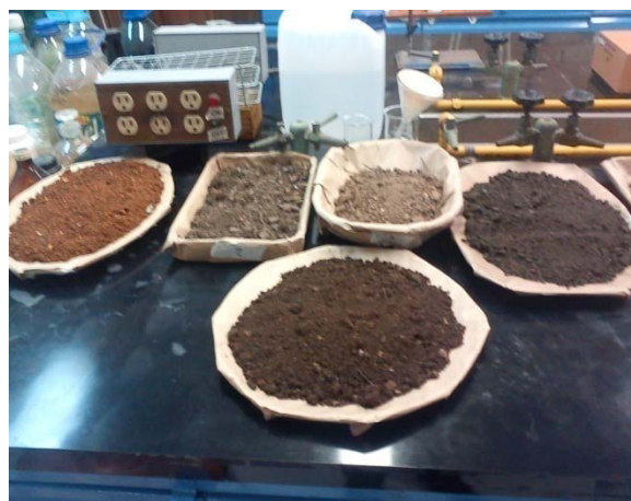
Figuras 13 y 14. Secado de muestras de suelo y jales a temperatura ambiente.
