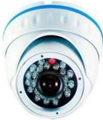
Figura 2.18 Cámara CCTV, Tipo Domo
