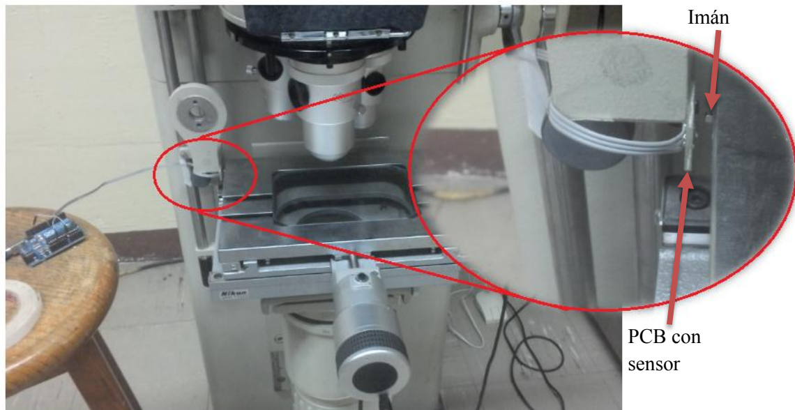
Figura 47. Experimento para caracterizar el sensor A1324 montado en un proyector de perfiles (NIKON Profile).
