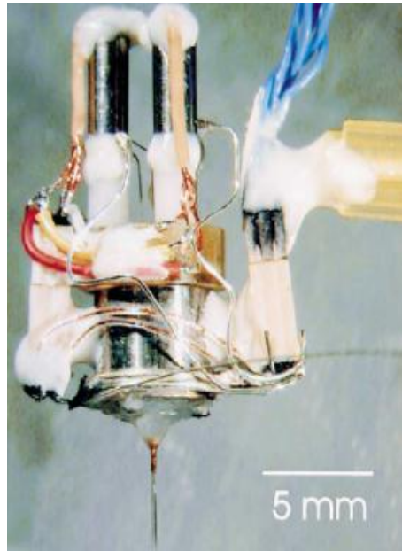
Figura 9. Microdrive con motores DC. Vista lateral del Microdrive completo cargado con electrodos y listo para su implantación. Una capa de acrilico se aplica a la parte inferior de la unidad para fijar el Microdrive en el cráneo [11].
